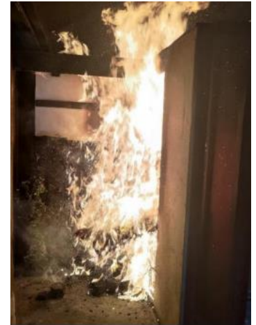
SBI test with dead plants - 150 s after test start Węgrzyńska et al 2023
